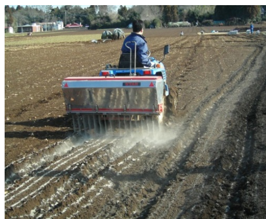
写真8 ライムソワーによる転炉スラグの散布
