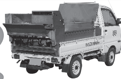
載せた堆肥をベルトコンベヤーで後部に運び、回転するピータで均一散布するため、スムーズな作業が可能です。
