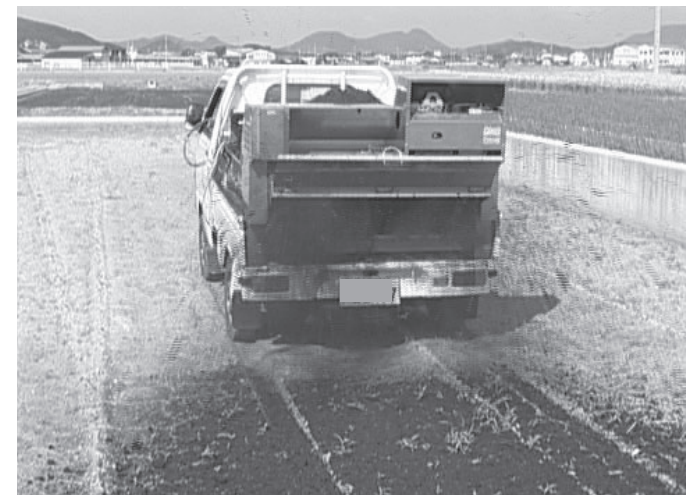
載せた堆肥をベルトコンベヤーで後部に運び、回転するピータで均一散布するため、スムーズな作業が可能です。
