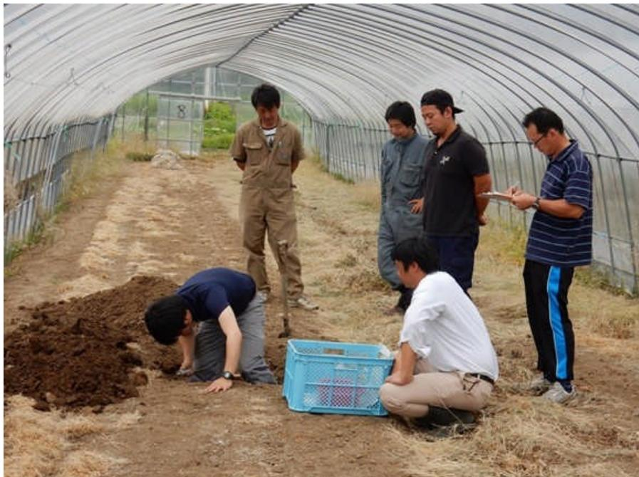
写真1 穴掘り調査での硬度測定
