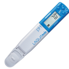
写真3 簡易型pHメーターの例「コンパクトpHメーター LAQUAtwin」(写真提供：株式会社堀場アドバンスドテクノ)
