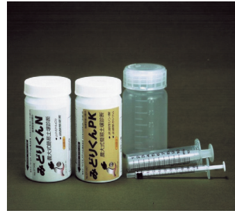
写真4 農大式簡易土壌診断キット「みどりくん」。「みどりくんN」でpHと窒素が、「みどりくんPK」でリン酸とカリが測定できる。
